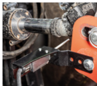
Senzor mecanism de ridicare braț superior
