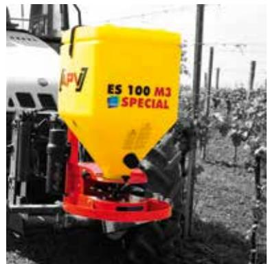
Mali rasipač KS i rasipač ES Classic sa jednim diskom priporučujemo za male do srednje velike radne zahvate. Rasipač serije Special postiže najviše vrednosti u preciznosti površinske podjele materijala (VK 9,4% kod 27 m radnog zahvata) Kod apliciranja peleta protiv puževa njih precizno razbacuje do 28 m. Ovaj model može se opremiti i senzorikom za klizač.
