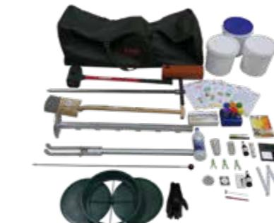
Pomoćom seta za analizu zemlje na jednostavan i brz način provjerite i analizirate kakvu zemlju obrađujete. Glavne mjeritve, koje možete napraviti tim setom jesu: mjerjenje pH zemlje, sadržaj nitrata, sadržaj karbonata, stabilnost razine humusa u zemlji, infiltracija poda, temperatura zemlje, razina ugnjetenja zelje, slojevi zemlje... Na taj način saznate u kakvoj kondicije je vaša zemlja i tome suklado prilagodite način obrade polja.
