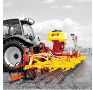
Drljača za pašnjake radi intenzivno i pouzdano s jedinstvenom kombinacijom zubaca od 10 mm i 8 mm. Agresivnost radnog postupka može se namjestiti individualno. Unatoč relativno malom zahtjevu snage tegljača, postići ćete visoko pokriće površine. Poravnanje, drljanje i naknadna sjetva – sve u jednoj fazi radnog procesa.
