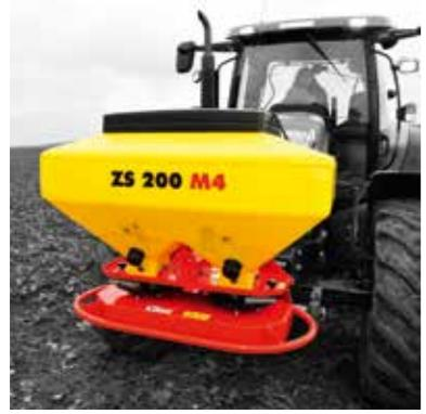
Rasipač sa dva diska postiže u konkurenciji rasipača peleta protiv puževa daleko najbolje rezultate. Sa do 31m širine rada i najboljom poprečnom distribucijom (krivulja rasipanja 11,9% na 31 m), najprecizniji je stroj za upotrebljavanje pužomora. To potvrđuju neovisne ispitne ustanove i ispitivanja praktičnosti od strane stručnih časopisa.
