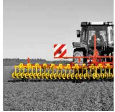
Rotosjeckalica odlična je za razbijanje tvrde skorenosti tla. Kolutovima drljače koji se okreću korov se prosipa ili čupa s korijenom, potiče se rast izdanaka i dovodi kisik u tlo. Takvim se rotirajućim načinom rada stroj neće začepiti. Kolutove drljače može se po želji namještati od 0 do 30 stupnjeva, a time osiguravaju savršen rezultat rada.
