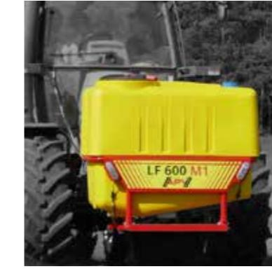
Dozator tekućih gnojiva omogučava startno đubrenje več kod same setve. Uz to je s njim moguće i precizno i efektivno aplicirati mikroorganizme, tekuće dodtke za siliranje, stabilizatore ra ras bilja, preparate za poboljšavanje kvalite zemlje u tekućom obliku. Upotreba senzora garancija je preciznog i tačnog apliciranja tečnosti. Upotrebnički može birati između puno različitih cjevi i dizni.
