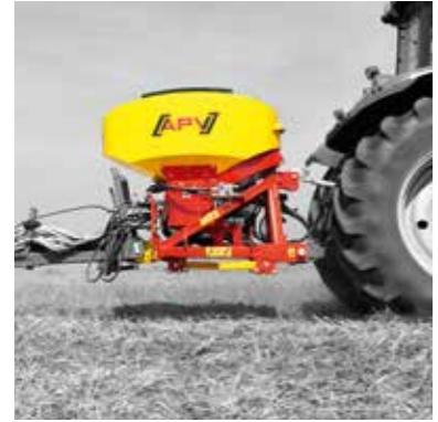
Nosač uređaja olakšava kombiniranje naših pneumatskih sijačica sa strojevima za obradu tla koje se vuče. Sijačica se montira na nosač uređaja, samo se crijeva i odbojni limovi nalaze na stroju za obradu tla. To rezultira savršenom raspodjelom težine: težina se nalazi na stražnjoj osovinici traktora umjesto na okviru stroja.
