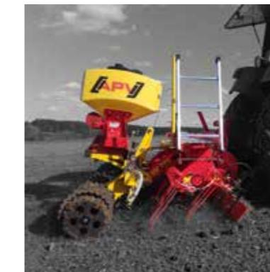
Kombinirani stroj za pašnjake odličan je za naknadnu sjetvu pašnjaka na brežuljkastom terenu. Njegova je velika prednost da ga se može voziti kao stražnji stroj, ali i odvojeno (drljača sprijeda, valjak straga) pa se može individualno prilagoditi vašim radnim potrebama. Dovoljan je manji traktor za normalnu upotrebu stroja.
