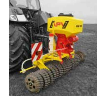
Da biste stvorili zatvaranje sjemena u tlo i time ciljano poboljšali klijanje sjemena, možete na razne načine upotrebljavati valjke za pašnjake. Valjci su dostupni u izvedbi Cambridge ili kao zupčasti valjak. Opcionalno možete za naknadnu i novu sjetvu nadograditi naše sijačice (Multidozator i pneumatska sijačica).
