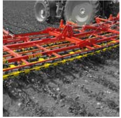
Vario drljača ima ugrađen jedinstven sistem konstantne prednapetosti opruga. Sistem omogućava mehaničku njegu i obradu oranica na najvišem mogućem nivou. Pritisak opruga na površinu je u bio kojem položaju opruga uvjek jednak. U praksi to znači, da se naša vario drljača može upotrebljavati i kod mehanskog ukljanjanja koreva kod kultura koje su sađeni ili sejani u t.z. visoke setvene gredice; npr. krompir. Posle obrade sa vario drljačom one sačuvaju svoj oblik.
