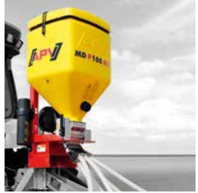
Linija Multidozatora objedinjava dobra svojstva naših pneumatskih sijačica i rasipača sa diskovima. Ovdje u prednjem planu stoje kompaktnost stroja i precizno doziranje! Zbog modularne strukture stroja, MD se može opremiti tanjurom za rasipanje kao i izlazima za doziranje s crijevima i ventilatorom.
