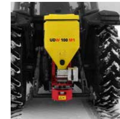
Rasipači za zimskui službu imaju ugrađeno dozirni mehanizam od inoxa. S njima može se precizno razsipati sol, pjesak i takođe mješavino pjeska i soli. Precizno doziranje putem dozirne osovine sa elektro pogonom bitna je karakteristika tog profesionalnog komunalnog stroja. Imamo i opcije strojeva koji se mogu kažti na ATV.
